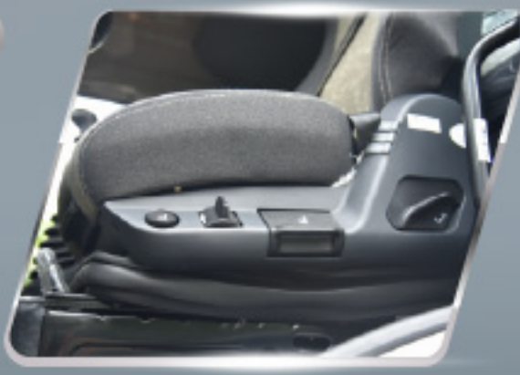
Ghế lái là ghế hơi với nhiều chế độ điều chỉnh
