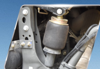
Hệ thống treo cabin: 4 bóng hơi cỡ lớn
