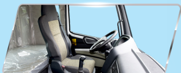
Ghế lái là ghế hơi với nhiều chế độ điều chỉnh
